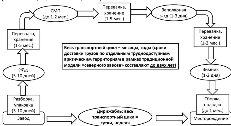
Рис. 1. Революционные возможности по доставке крупногабаритных и тяжелых грузов на территории со слаборазвитой или отсутствующей инфраструктурой
