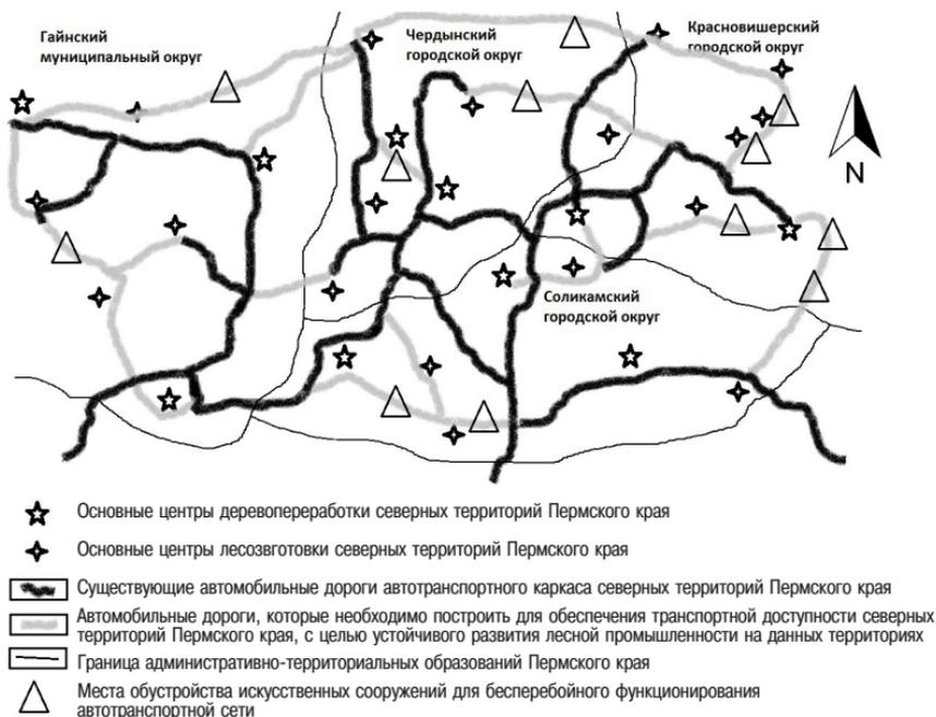
Рис. 8. Модель оптимального транспортного каркаса для северной части Пермского края
