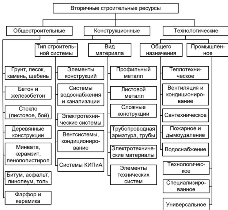
Рис. 1. Классификация вторичных строительных ресурсов по технико-технологическим признакам
