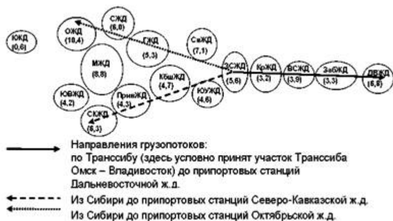
Рис. 2. Условная схема железных дорог РФ (расшифровку обозначений железных дорог см. в таблице; в скобках – протяжённость железной дороги, тыс. км)
